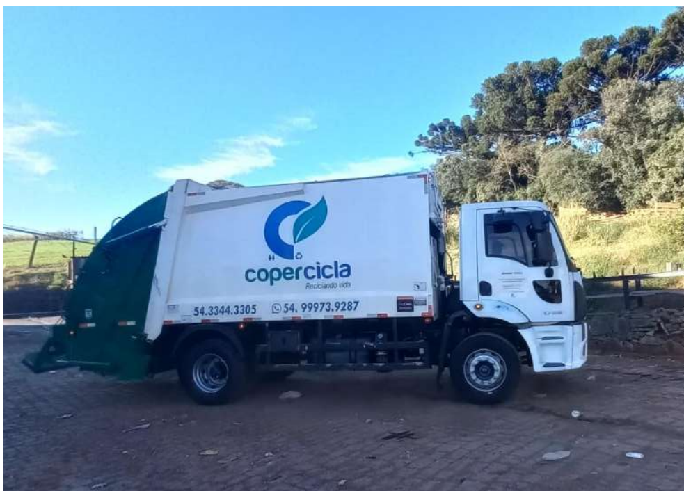
Figura 19 – Caminhão do tipo compactador
